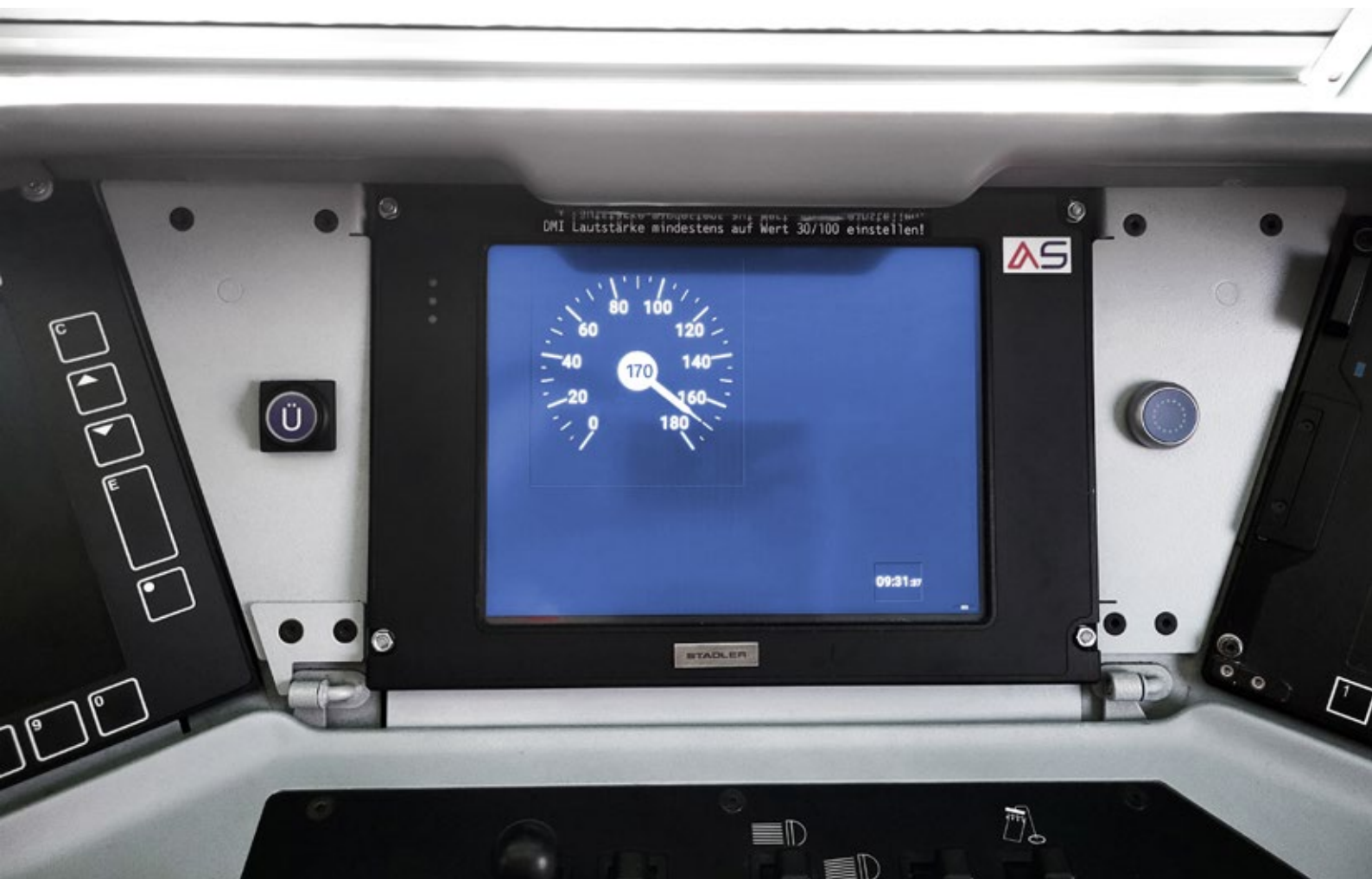
Stadler und sein Joint Venture AngelStar haben Lokomotiven der Deutschen Bahn auf ETCS erstmals ohne Einbindung des Lokomotivherstellers umgerüstet.
