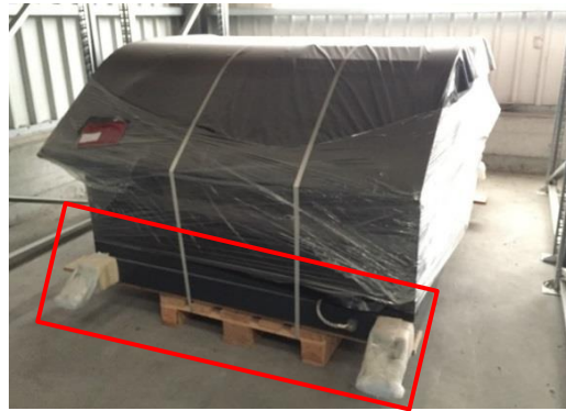
Abbildung 3 Beispiel einer falschen Ladeinheit
