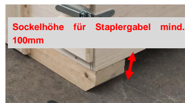
Abbildung 1 Bildliche Darstellung der Anforderungen für Nicht-Standardladungsträger
