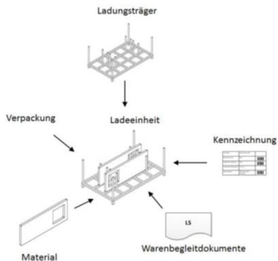
Abbildung 7: Bildung einer Ladeinheit zur Liefervariante 3
