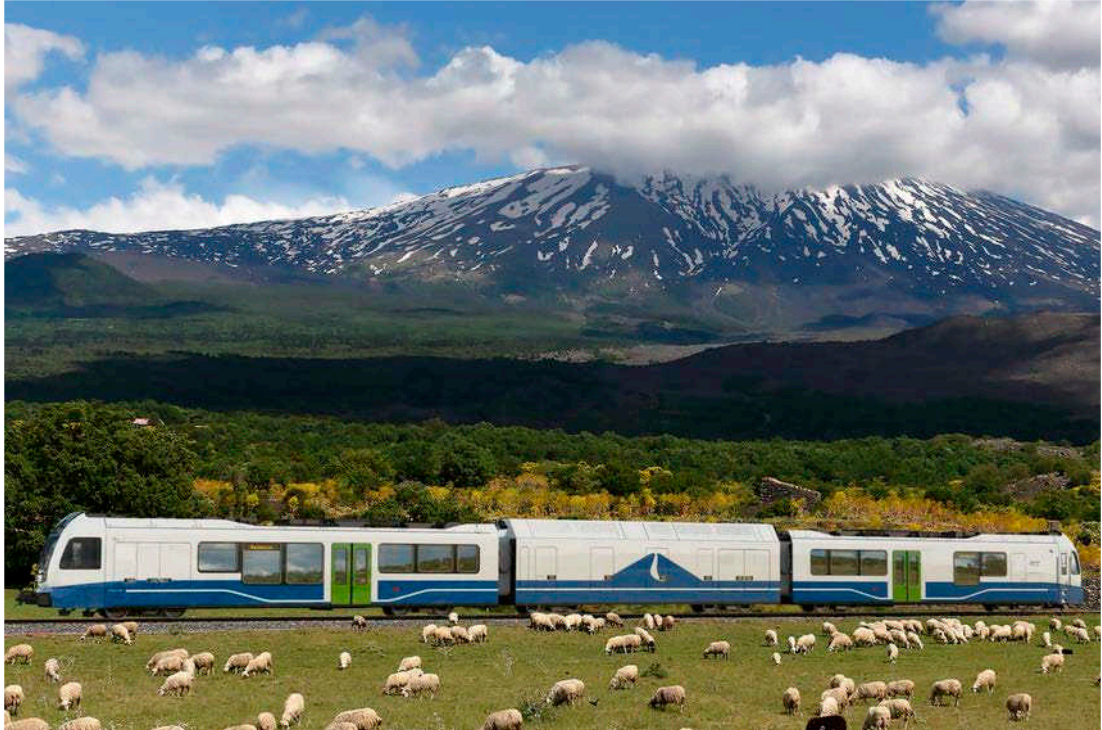
Die neuen Wasserstoffzüge für Sizilien werden voraussichtlich ab 2028 entlang des Ätna-Naturparks fahren. Jedes Fahrzeug besteht aus zwei Personenwagen und einem zentralen «Power Pack», das unter anderem den Wassertank enthält.
