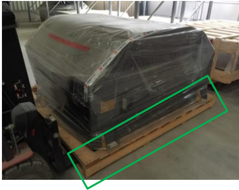
Abbildung 1 Beispiel einer korrekten Ladeinheit
