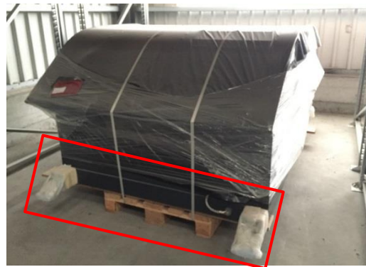
Abbildung 2 Beispiel einer falschen Ladeinheit
